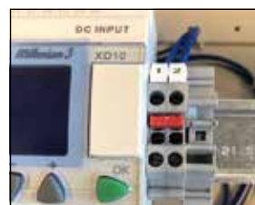
(Draadbrug t.b.v. gravitaire opstelling)
