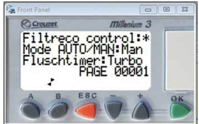
Display met handmatige spoelcyclus
