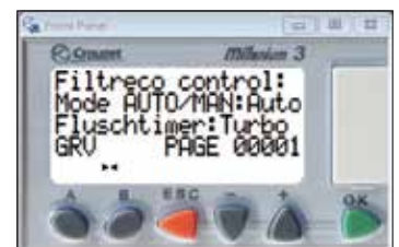
(Display met gravitaire software)
